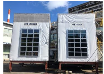
透明な窓用太陽光発電パネルの実証実験
